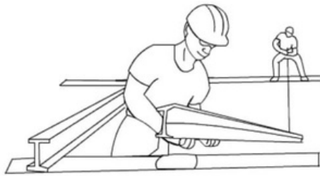
SUBIR Y NIVELAR LAS VIGAS
