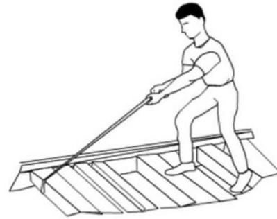
COLOCACIÓN DE LAS LOSAS D'CASSTER'S
