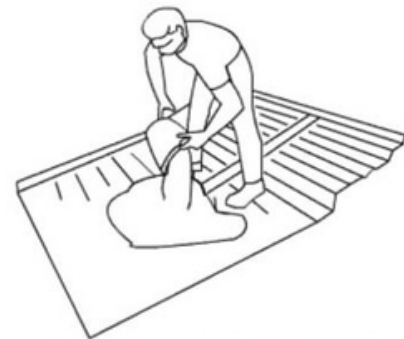
APLICACIÓN DE HORMIGÓN DE TERMINADOS Y NIVELACIONES
