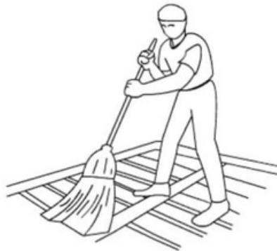
APLICACIÓN DE LECHADA
